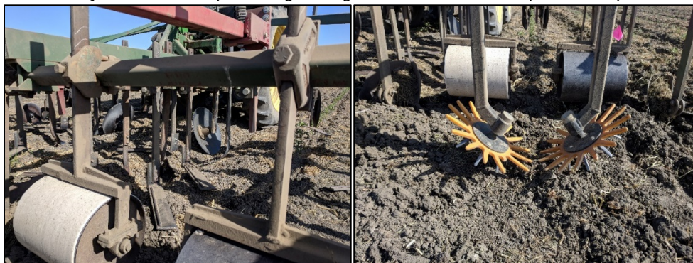
Left: Double-disc opener. Right: Finger weeder attachment (KULT Kress).
